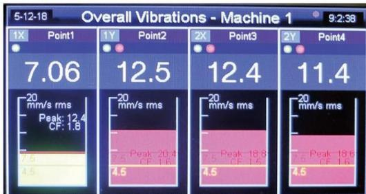
نمایش تصویری و عددی مقادیر جاری و حدود هشدار و خطر، به همراه اعلان وضعیت هشدار و خطر و خطا و امکان نمایش مقادیر مکمل به همراه نمایش LED وضعیت مدیریت هشدارها و عکس العمل ری ست و اکتالچ و همچنین LED های عملکرد و پردازش، همگی با هم یک نمایش کامل کم نظیر برای مانیتورینگ حفاظتی را فراهم کرده است.
